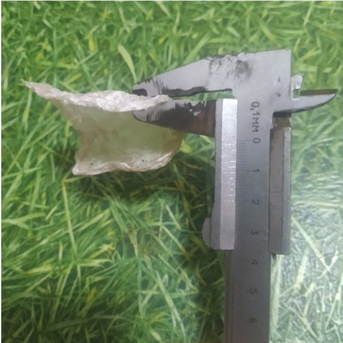
Рис.8 Измерение толщины экспериментальных плёнок штангенциркулем.
