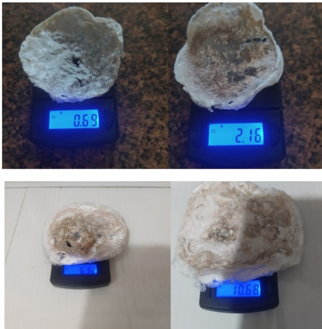
Рис.13-16. Результаты впитываемости влаги из атмосферного воздуха плёнками в помещении со средней влажностью 55,25%
