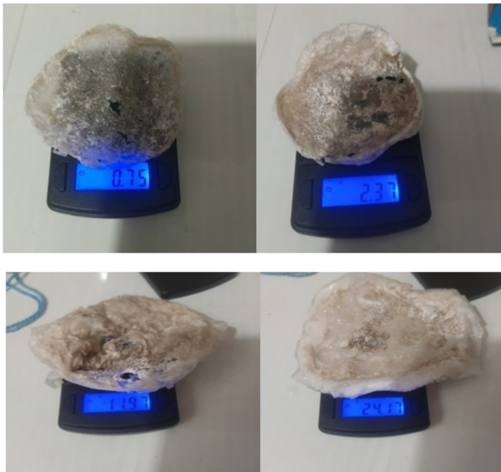
Рис.21-24. Результаты впитываемости влаги из атмосферного воздуха плёнками в помещении со средней влажностью 97,25%.
