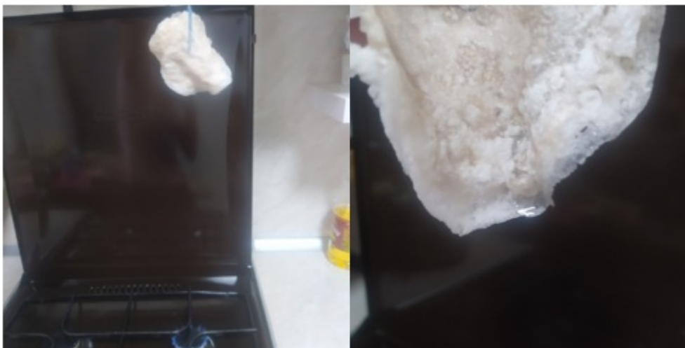
Рис.25 Высвобождение аккумулированной плёнкой влаги частыми каплями при небольшом
