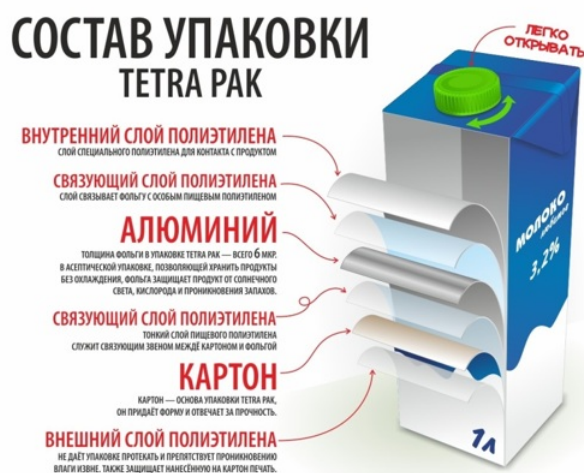
Рисунок 1. Структура многослойной упаковки тетрапак.
