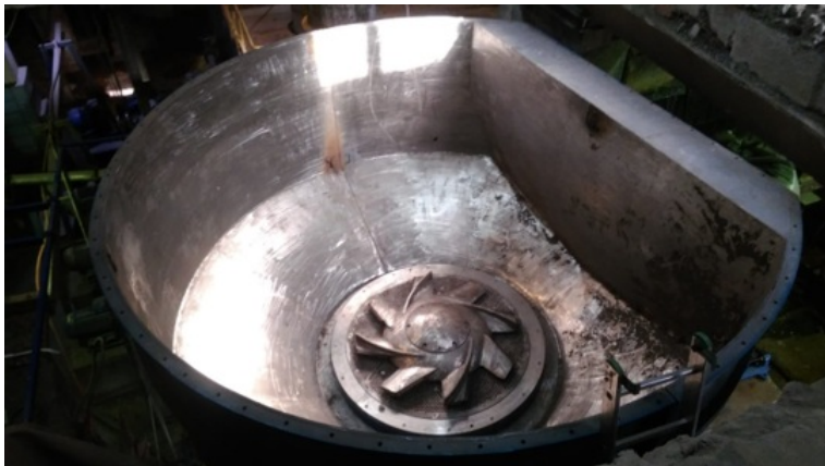
Фото 1. Бак с ротором гидроразбивателя.
