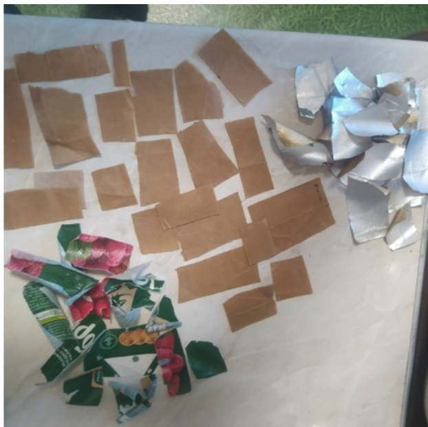
Фото 5. Результаты роспуска тетрапака в автоклаве на картон, бумагу и полиалюминиевую смесь, упорядоченный вид.
