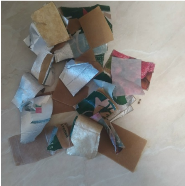
Фото 4. Результаты роспуска тетрапака в автоклаве после извлечения из устройства, неупорядоченный вид.
