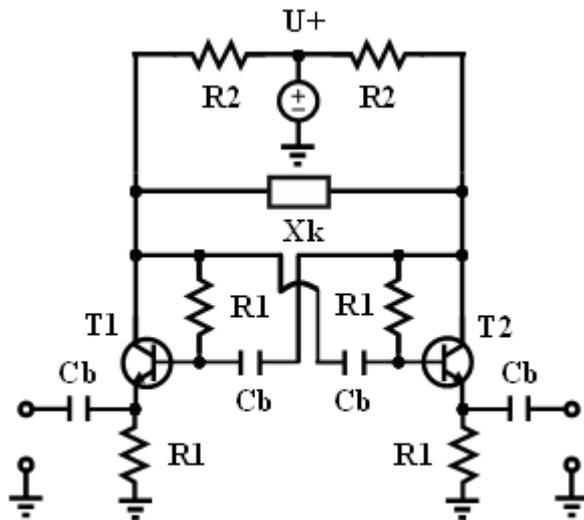
Рисунок 3 — Схема КОО на биполярных транзисторах
