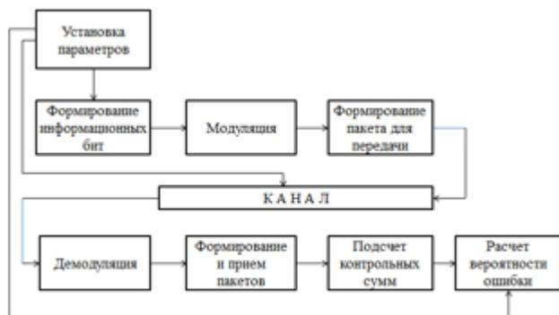
Рисунок 1. Блок-схема имитационного моделирования.
