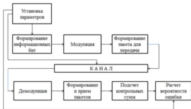
Рисунок 1. Блок-схема имитационного моделирования.
