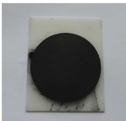
Рисунок 2 – Распыляемая мишень из порошка \text{Ge}_2\text{Sb}_2\text{Te}_5 [2].
