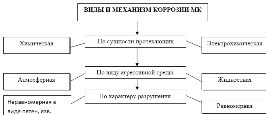
Рис.2 Виды коррозии металлических конструкций.
