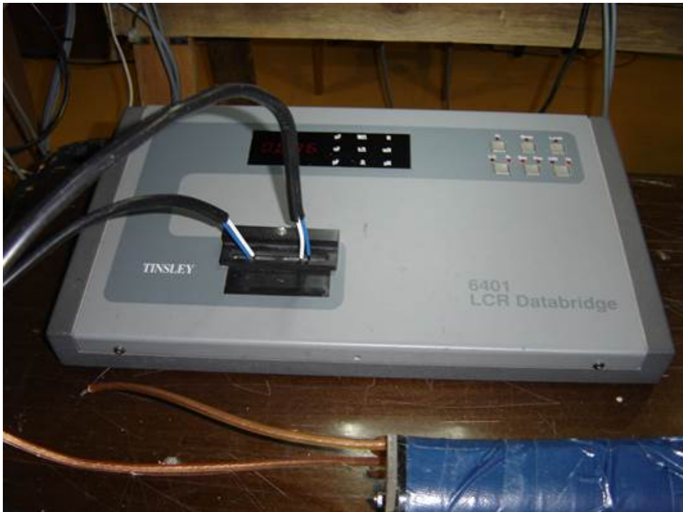
Фото.10. Измерение параметров обмотки «подмагничивания» модели ЛМАН № 20м1. Внешний вид в герметичной оболочке собственноручно разработанной и изготовленной автором модели ЛМАН № 20м1 представлен на Фото.11.
