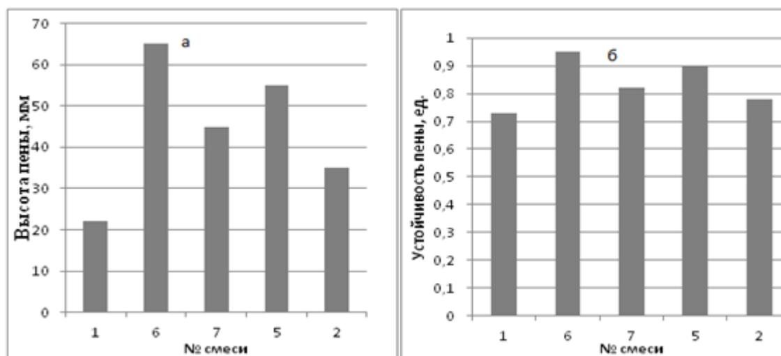
Рис. 1. Пенообразующая способность растворов бинарных смесей ПАВ: а) высота столба пены ( ); б) устойчивость пены ( $H_5/H_0$ ).
