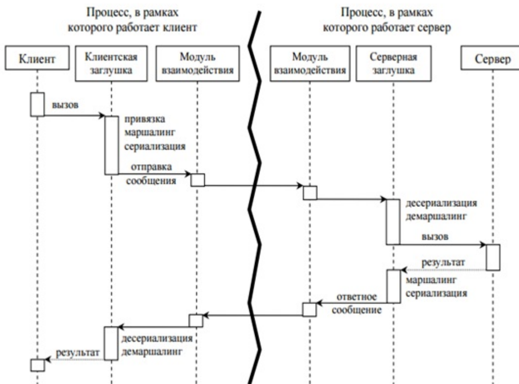
Рисунок 3 — Схема реализации удалённого вызова процедуры
