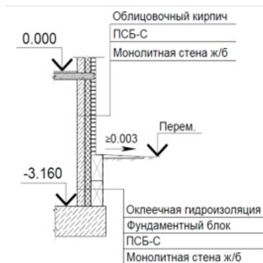
А. Разрез наружной конструкции
