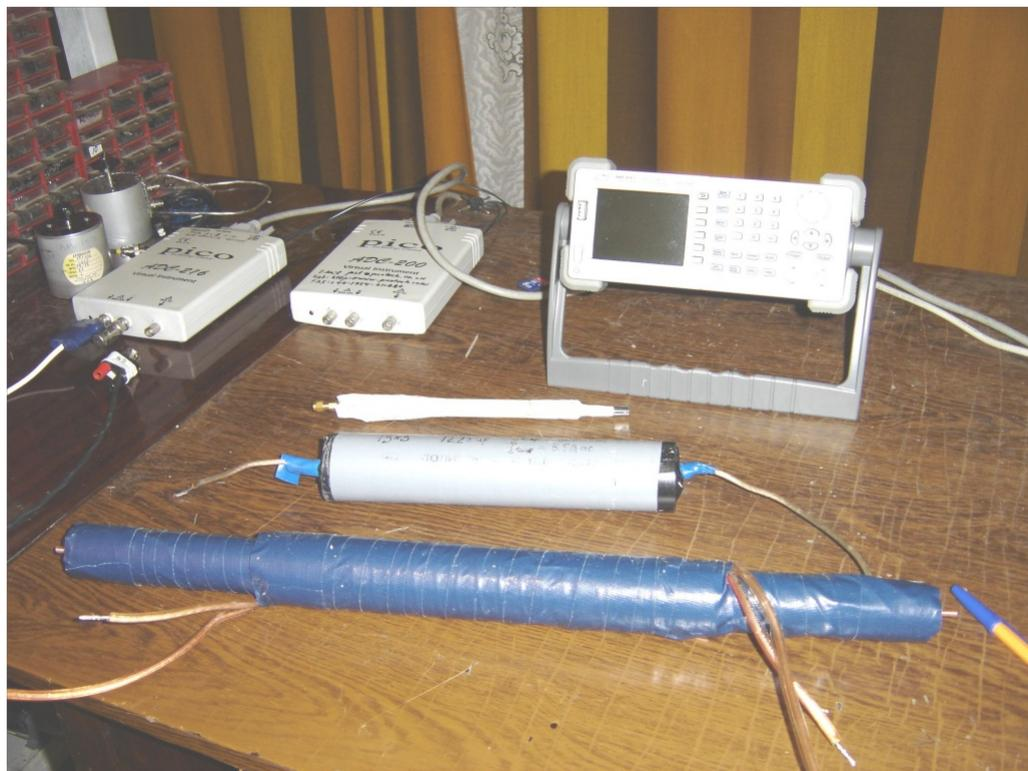
**Фото 1. На переднем плане вид модели ЛМАН<sup>№21</sup> и модель резонансный конденсатора для частоты 30 КГц, рассчитанные для работы при  $I_{ам}$  до 8 А [3] .**
