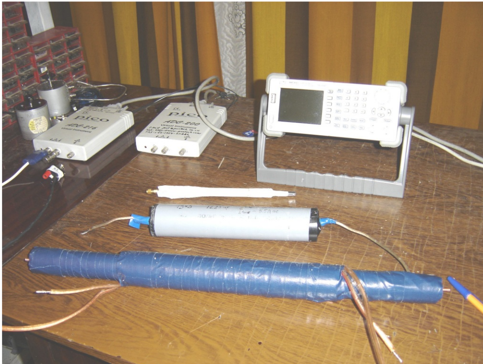
Фото 1. На переднем плане вид модели ЛМАН№21 и модель резонансный конденсатора для частоты 30 КГц, рассчитанные для работы при I_{ам} до 8 А [3] .
