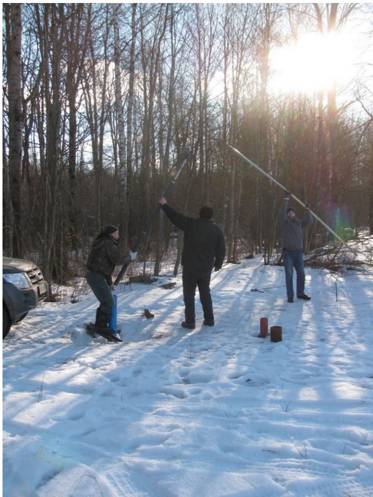
Фото. 3. Геофизики Компании "Радионда" в момент погружения антенных корпусов, в которых находятся Модель ЛМА № 21 и Модель МАН № 2 в скважины Испытательного полигона Геологического Факультета МГУ в Московской Области во время теста
