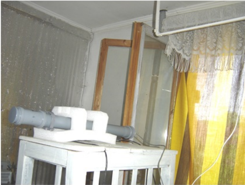
Фото. 2. Модель MAN² в герметичном кожухе, а выше справа Рамочная приёмная антенна ЛАН¹ (Aэфф = 0.25 кв.м, N=100 витков).
