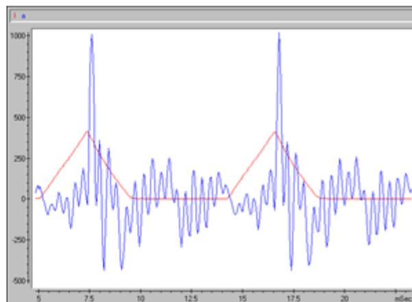
Рис. 13. Осциллограмма тока фазы и виброускорения при  $f = 109$  Гц ( $T_{\text{ком}} = 9,2$  мс), по прибору,  $a = 1,3$  м/с<sup>2</sup>
