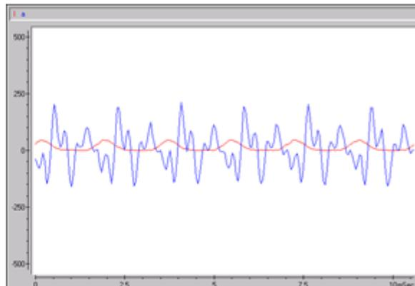
Рис. 7. Осциллограмма тока фазы и виброускорения при  $f = 562$  Гц ( $T_{\text{ком}} = 1,78$  мс), по прибору,  $a = 1,9$  м/с<sup>2</sup>
