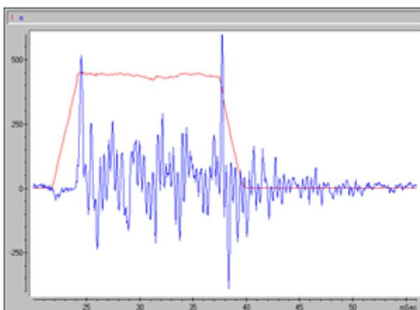
Рис. 14. Осциллограмма тока фазы и виброускорения при  $f = 62$  Гц ( $T_{\text{ком}} = 62$  мс), по прибору,  $a = 0,43$  м/с<sup>2</sup>
