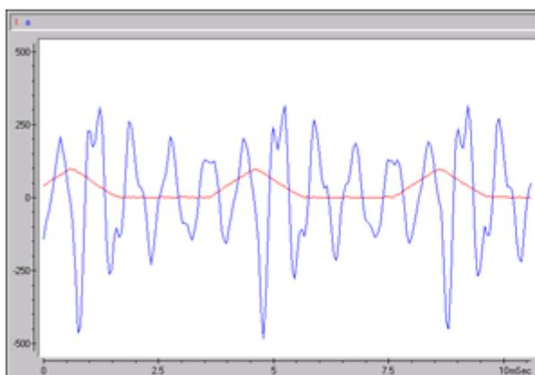
Рис. 8. Осциллограмма тока фазы и виброускорения при  $f = 247$  Гц ( $T_{\text{ком}} = 4,05$  мс), по прибору,  $a = 3,6$  м/с<sup>2</sup>
