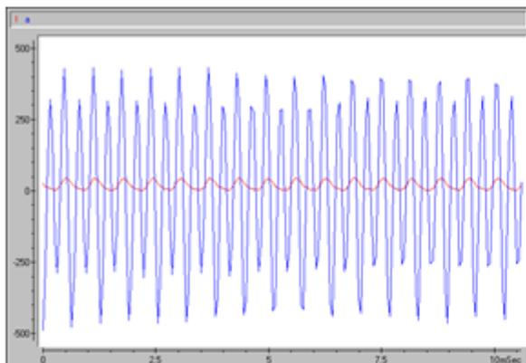
Рис. 6. Осциллограмма тока фазы и виброускорения при  $f = 1587$  Гц ( $T_{\text{ком}} = 0,63$  мс), по прибору,  $a = 6,2$  м/с<sup>2</sup>
