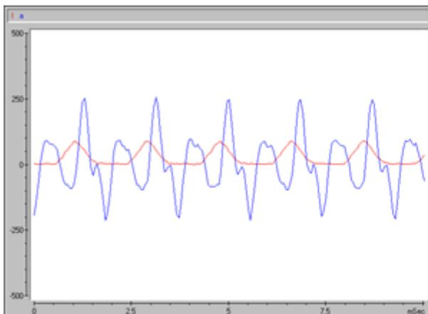
Рис. 12. Осциллограмма тока фазы и виброускорения при  $f = 544$  Гц ( $T_{\text{ком}} = 1,84$  мс), по прибору,  $a = 0,77$  м/с<sup>2</sup>
