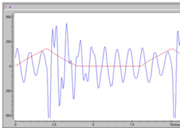
Рис. 9. Осциллограмма тока фазы и виброускорения при  $f = 123$  Гц ( $T_{\text{ком}} = 8,1$  мс), по прибору,  $a = 4,0$  м/с<sup>2</sup>
