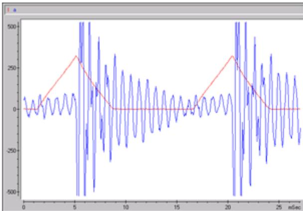
Рис. 10. Осциллограмма тока фазы и виброускорения при  $f = 65$  Гц ( $T_{ком} = 15,4$  мс), (по прибору,  $a = 4,2$  м/с<sup>2</sup>)
