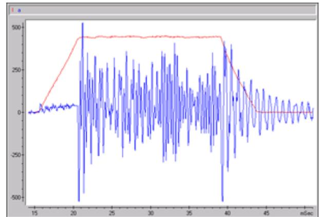
Рис. 11. Осциллограмма тока фазы и виброускорения при  $f = 10,5$  Гц ( $T_{ком} = 95$  мс), (по прибору,  $a = 1,6$  м/с<sup>2</sup>)
