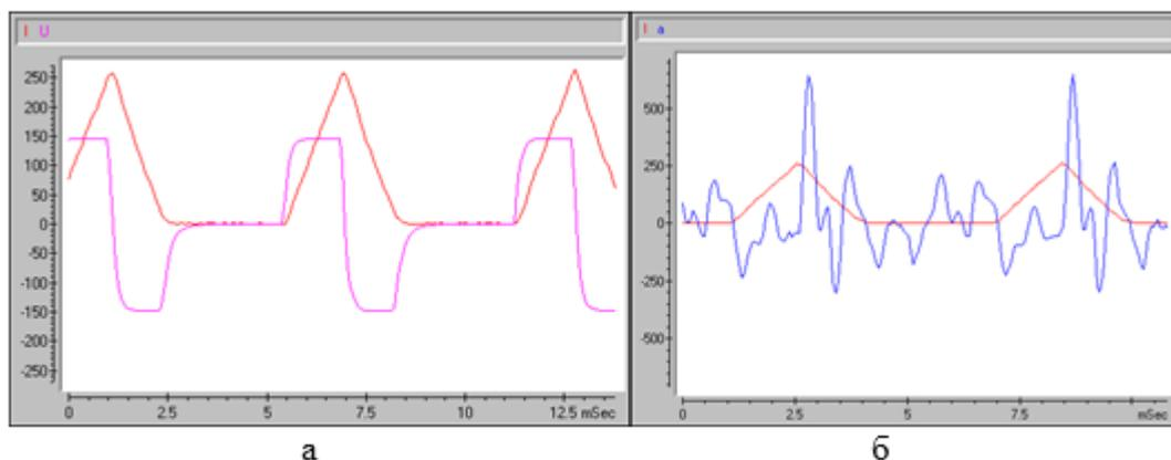
Рис. 4. Пример осциллограмм тока и напряжения фазы (а) и тока фазы и виброускорения (б) при  $T_{\text{ком}} = 0,63$  мс, (по прибору,  $a = 6,2$  м/с<sup>2</sup>)
