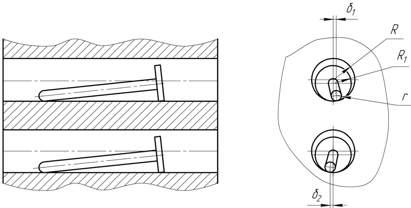
Рис.1. Базирование типовых стержневых деталей в цилиндрическом отверстии
