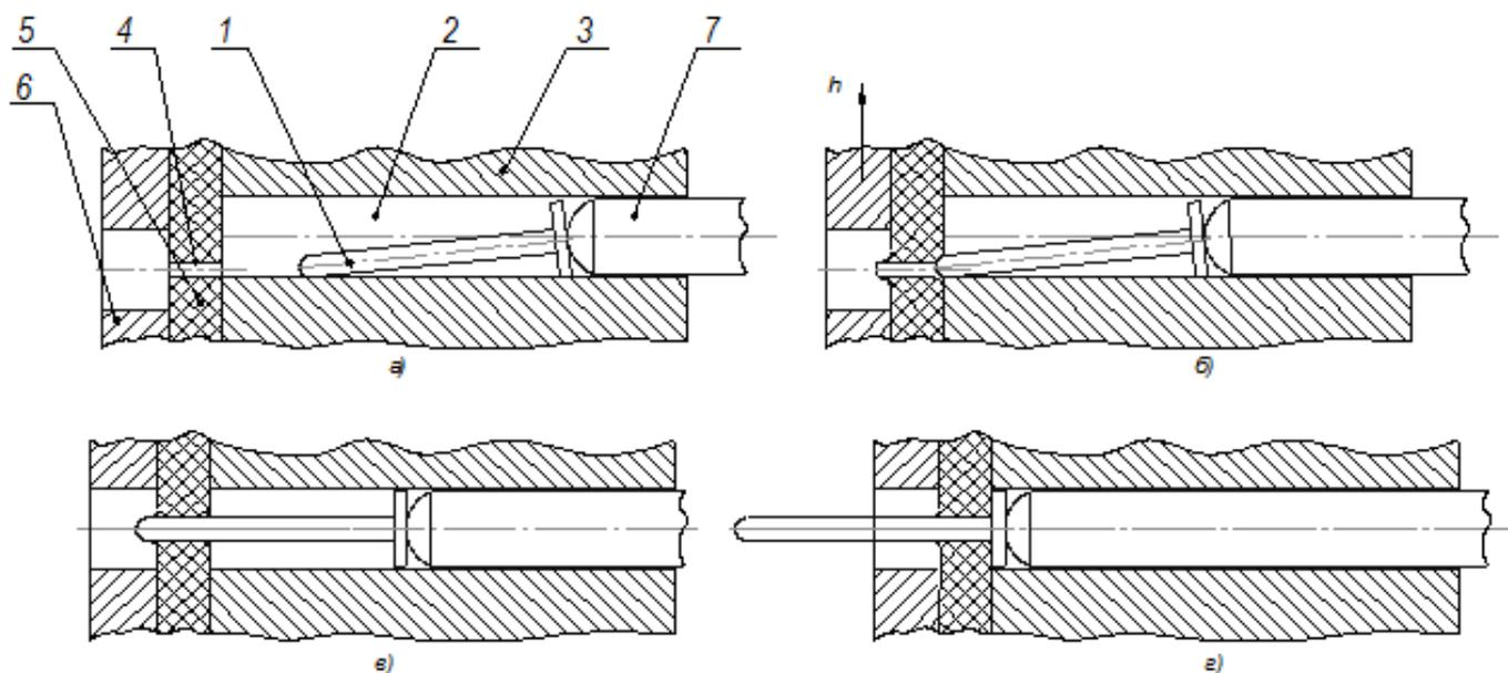
Рис.2. Приемы одновременной автоматической сборки многоэлементных изделий<.р>
