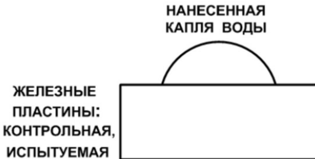
Высыхание капель воды на пластинах происходит за 45 – 55 минут в зависимости от температуры и влажности окружающего воздуха.
