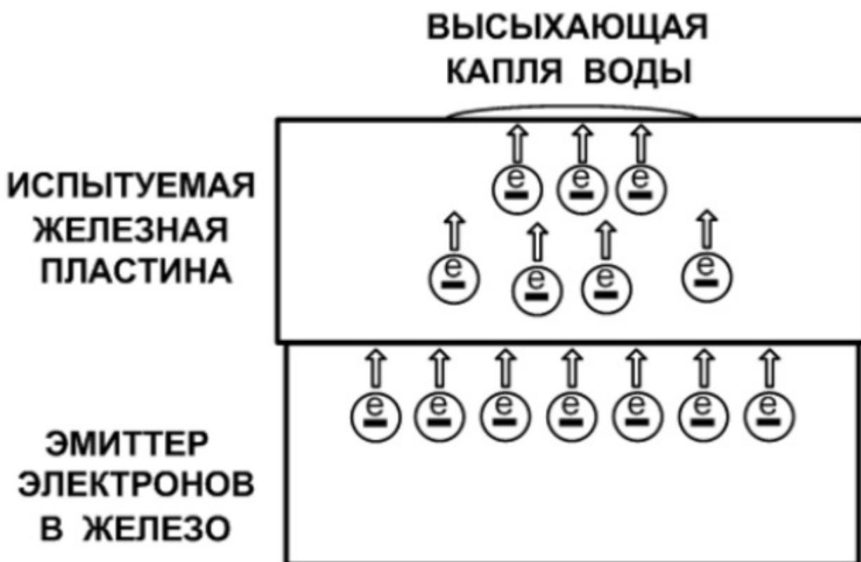
При этом фаза образования ржавчины  $\text{Fe}_2\text{O}_3$  не успевает наступить, блокируется. После высыхания капли воды на поверхности испытуемой пластины остаётся пятно серого цвета, его можно удалить мягкой тканью. Поверхностная структура испытуемой пластины не изменена.
