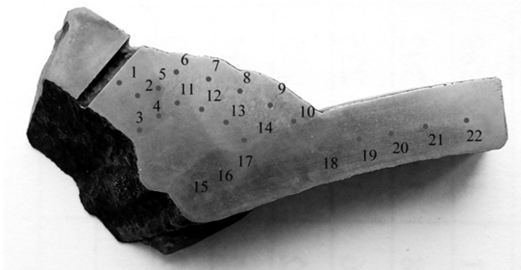
Рисунок 10 - Общий вид микрошлифа с указанием точек измерения микротвердости
