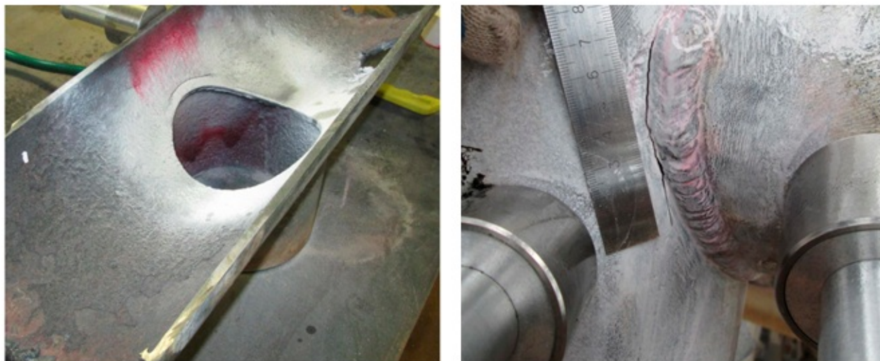
Рисунок 2 – Проведение магнитопорошкового контроля: а) – с внутренней стороны; б) - с наружной стороны.
