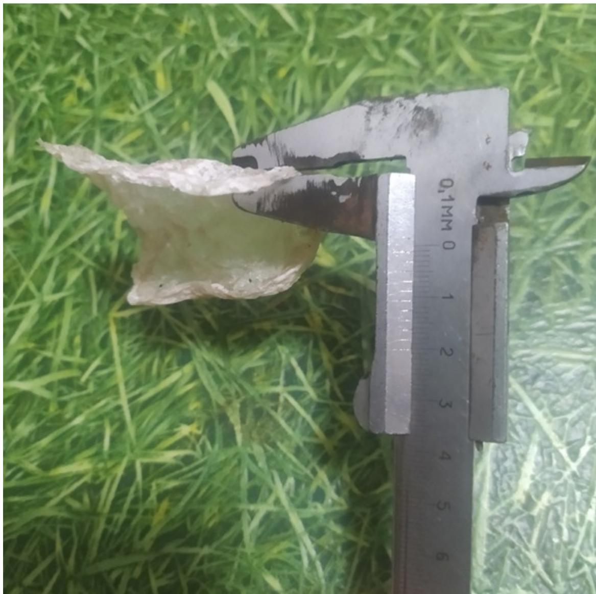
Рис.8 Измерение толщины экспериментальных плёнок штангенциркулем.
