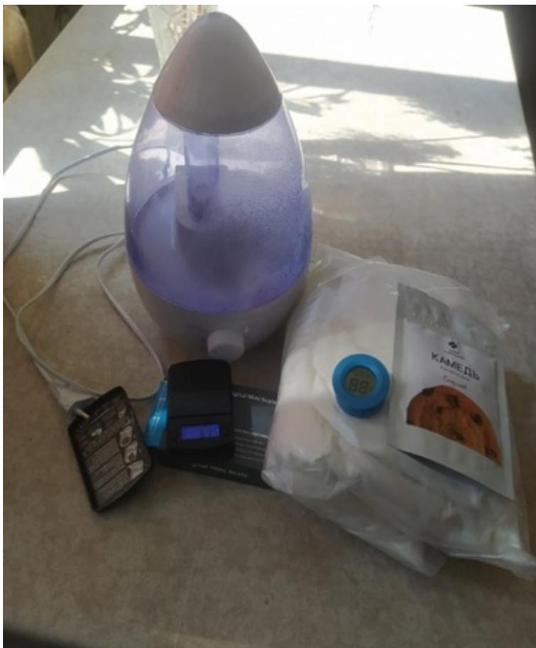
Рис.1 - Необходимый экспериментальный набор: порошок конжаковой камеди, целлюлозный порошок, высокоточные весы, увлажнитель воздуха,гигрометр.
