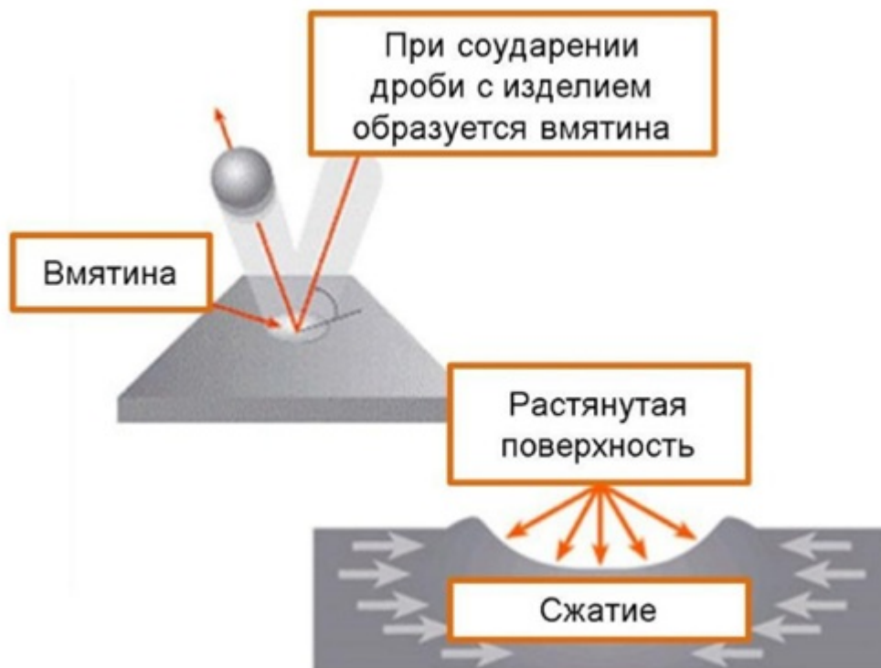
Рисунок 1 — процесс формирования упрочняющего слоя.
