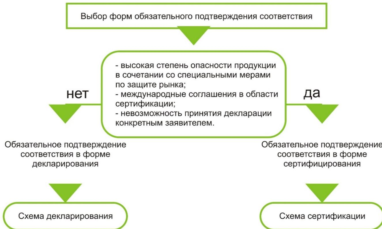
Рис. 1. Блок-схема выбора форм обязательного подтверждения соответствия.
