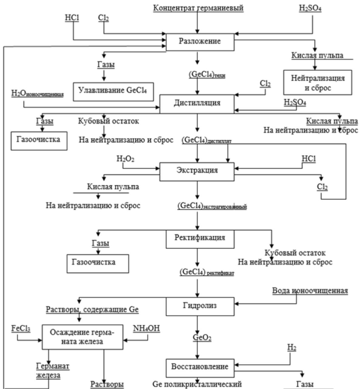
Рисунок 1 — Технологическая схема получения германия из окисленного сырья
