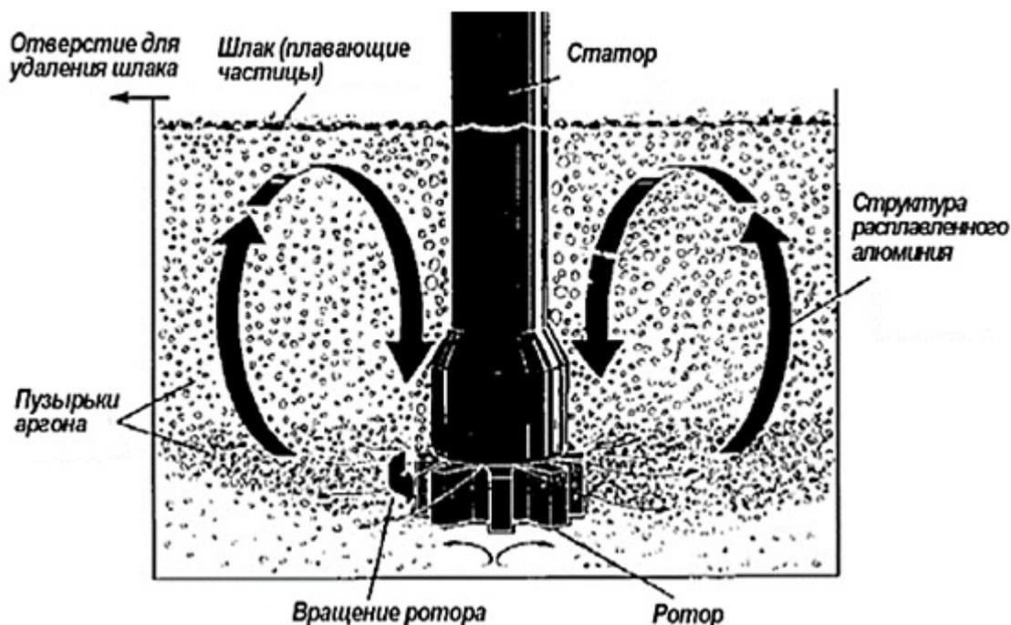
**Рисунок 1. Принцип инжектирования газов хлора/аргона в расплав системы дегазации «SNIF».**
