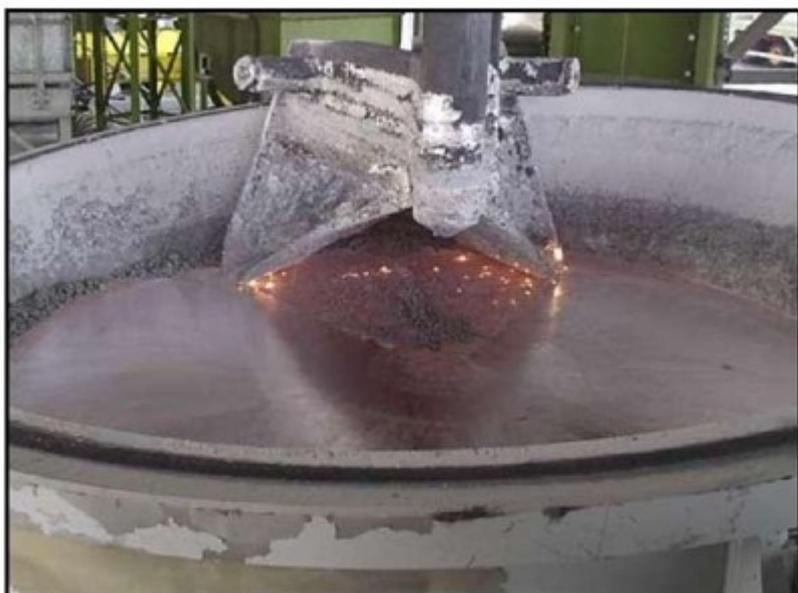
**Рисунок 3. Приспособление для удаления шлака.**
