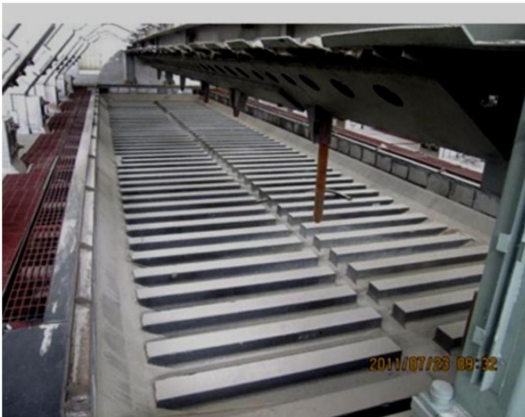
Рисунок 2 — Катоды прямоугольной выпуклой конструкции
