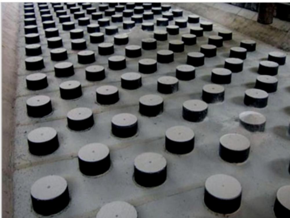
Рисунок 3 — Катоды цилиндрические выпуклые
