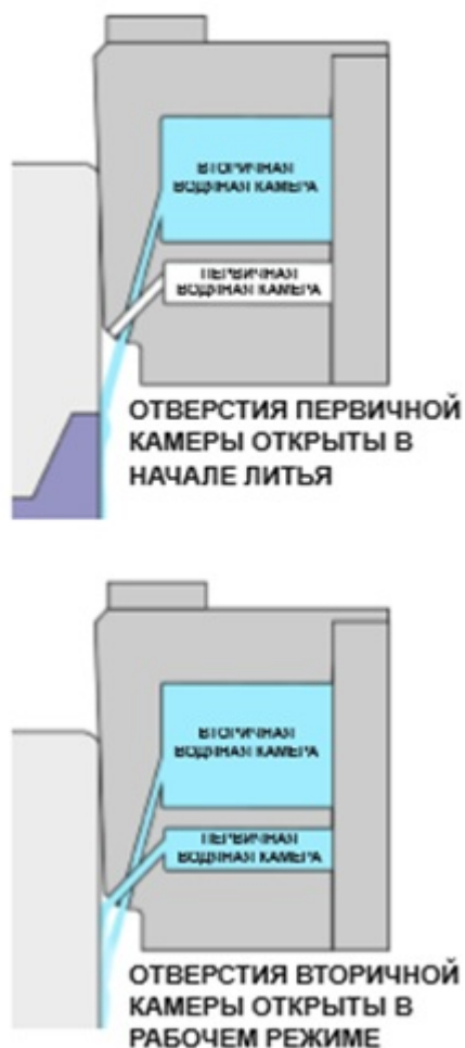
Рисунок 2 — Два способа подача воды технологии SplitJet: из одной или двух камер
