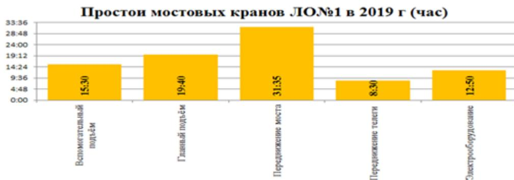
Рисунок 1- График простоев мостовых кранов в разрезе механизмов
