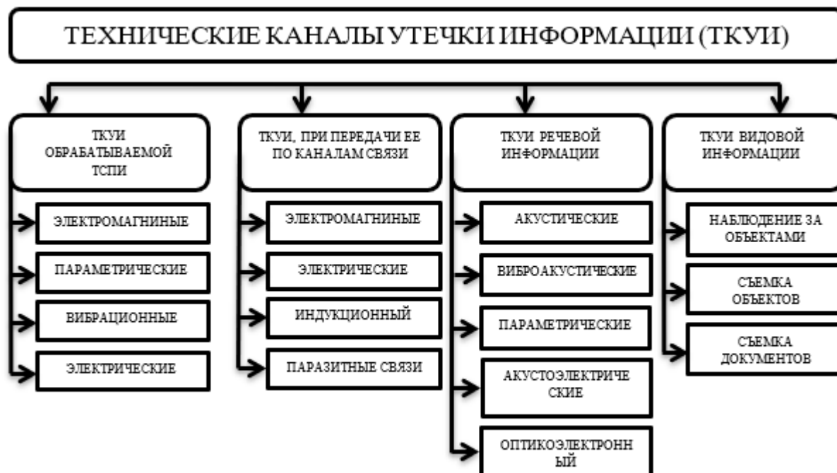
Рис. 2 классификация технических каналов утечки информации
