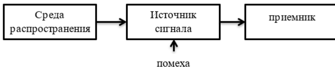
Рис. 1 принципиальная схема технического канала утечки информации
