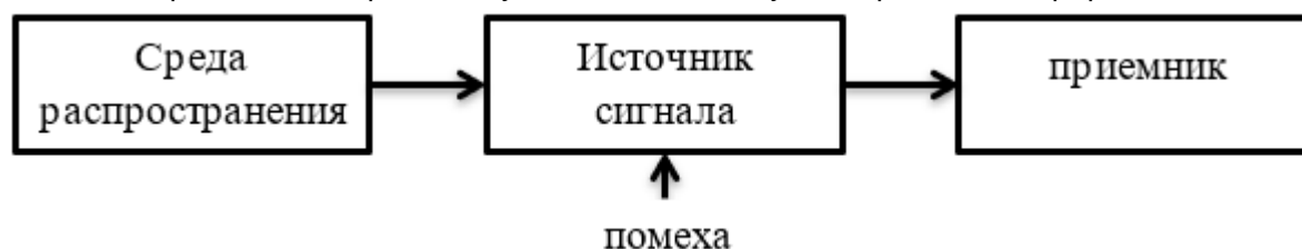
Рис.3 схема прямого акустического канала утечки речевой информации
