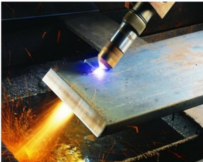
Рисунок 1 — Изменение угла резания плазмоторна
