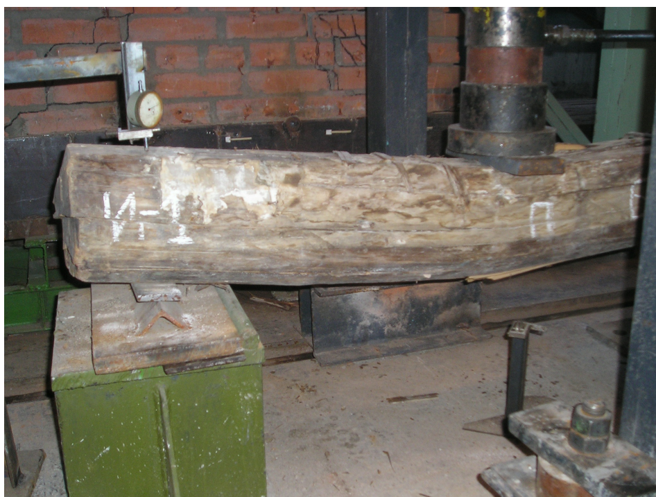
Рисунок 3. Испытание балок из «старой» древесины
