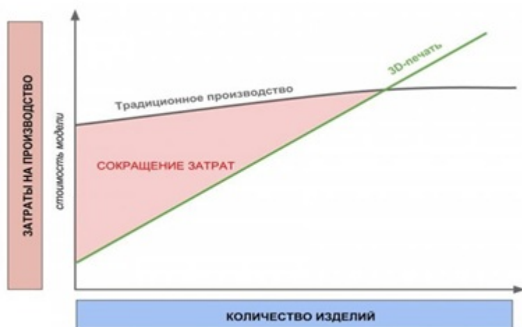
Рис.2 — Сравнение Традиционного производства и 3D — печать.
