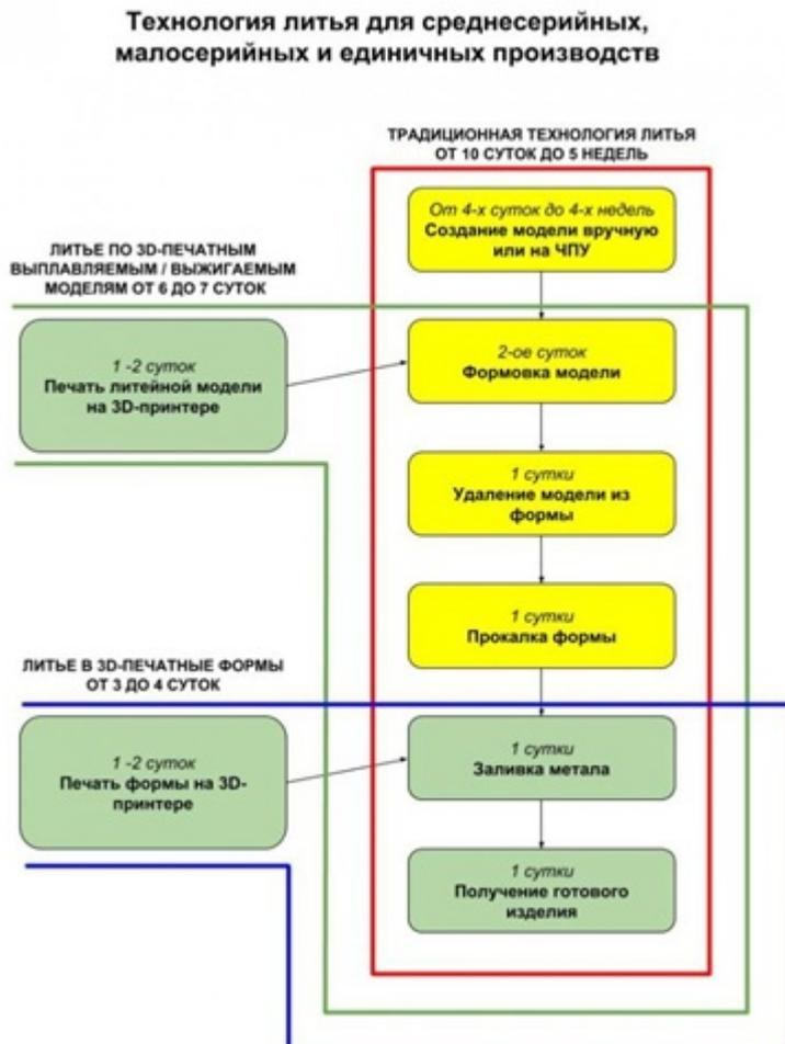
Рис.1 — Сравнение технологий Традиционного производства и 3D — печати.
