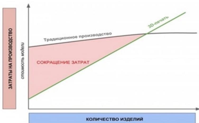
Рис.2 — Сравнение Традиционного производства и 3D — печать.
