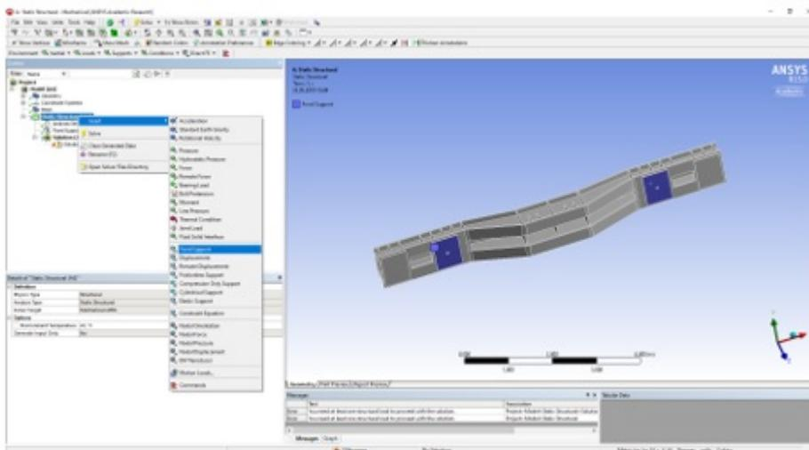
Рисунок 3 — Закрепление балки в окне Model
