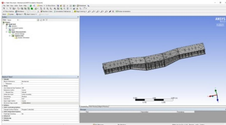
Рисунок 2 — Разбивка балки на сетку в окне Model
