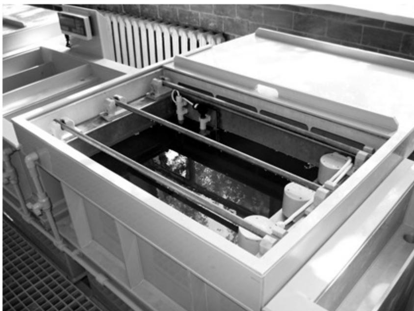
Рисунок 2 — Гальваническая ванна
