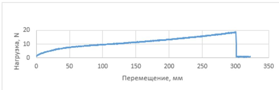
Рисунок 5 — График зависимости перемещения от нагрузки 1-го образца
