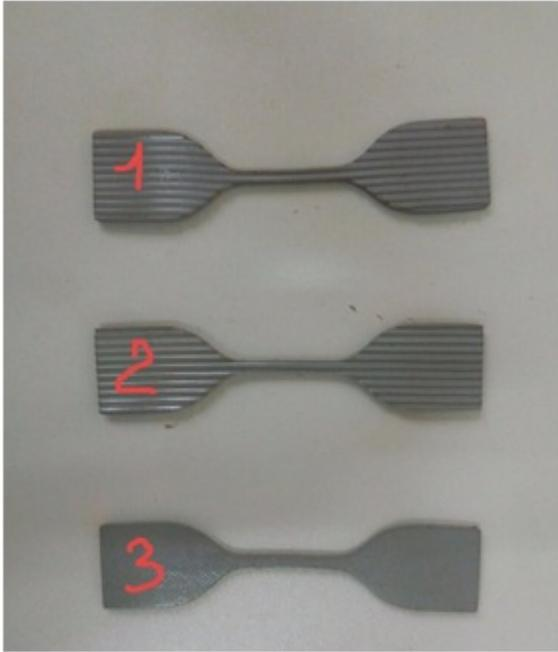
Рисунок 2 — Образцы-лопатки
