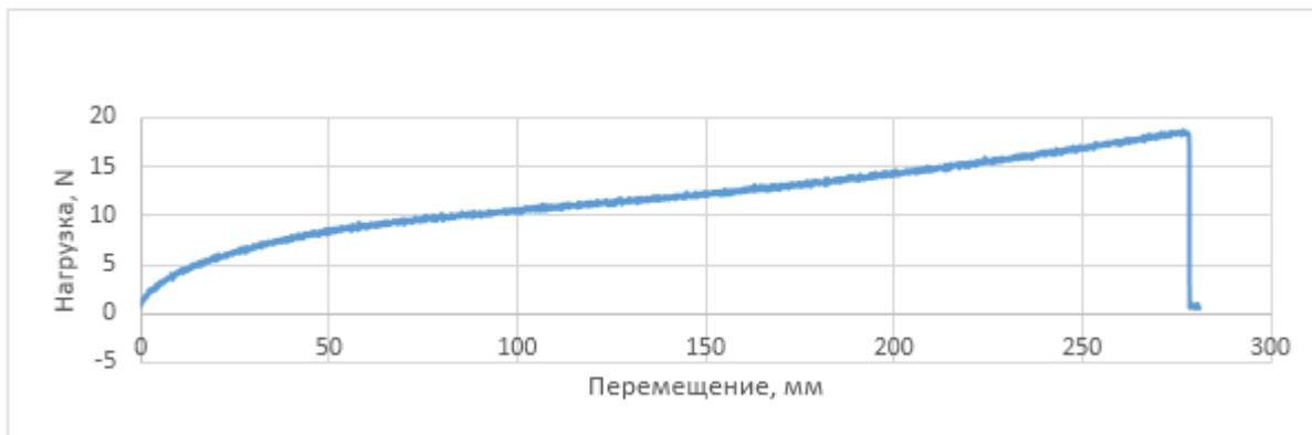
Рисунок 6 — График зависимости перемещения от нагрузки 2-го образца
