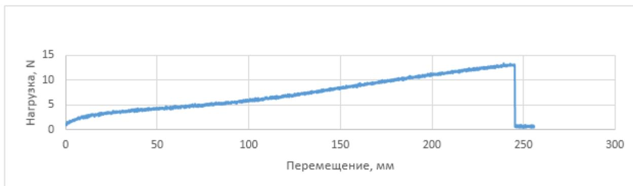
Рисунок 7 — График зависимости перемещения от нагрузки 3-го образца
