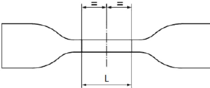
Рисунок 1 — Форма образца лопатки
