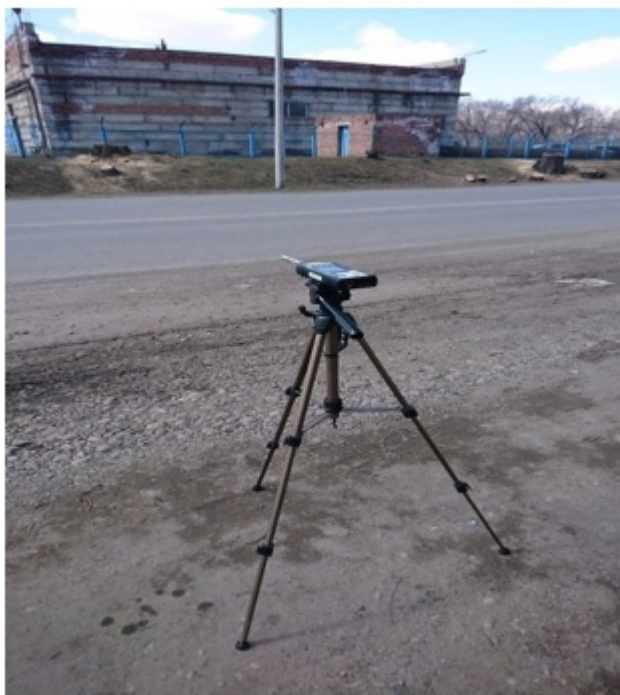
Рисунок — Пример установки шумомера (фото автора)
