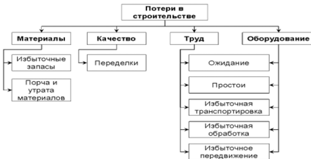
Рисунок 1 — Виды потерь в строительстве
