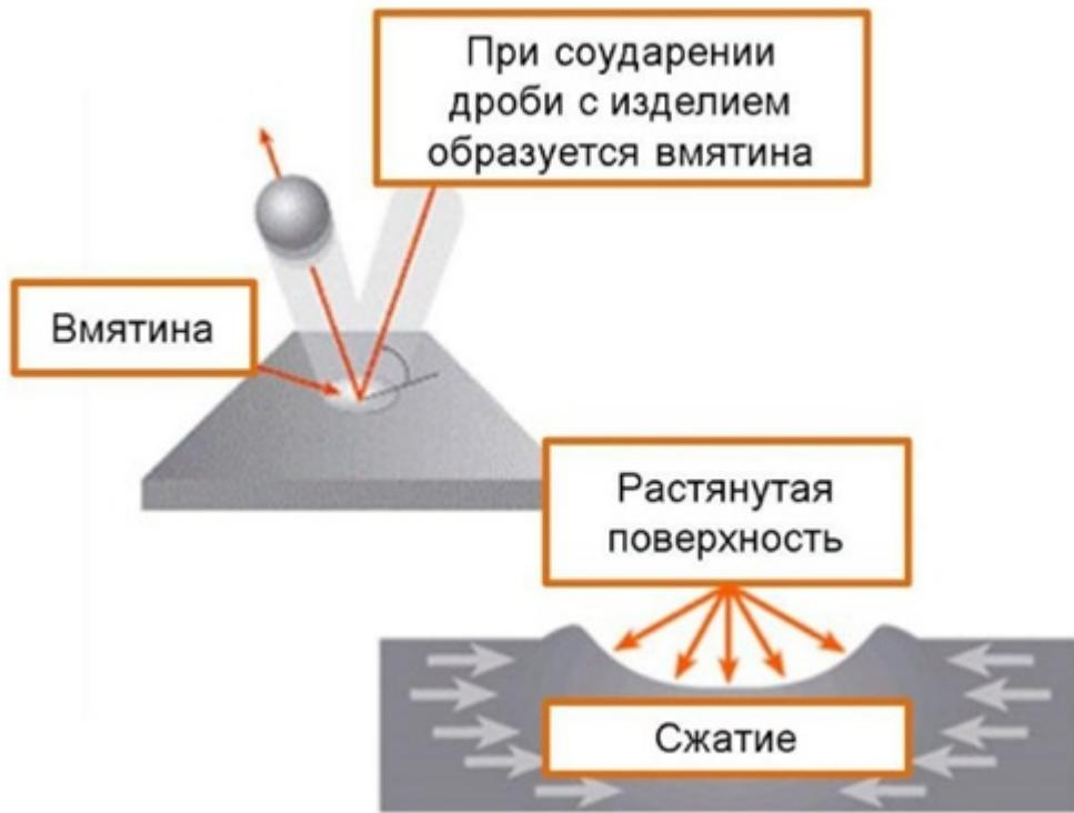
Рисунок 1 — процесс формирования упрочняющего слоя.
