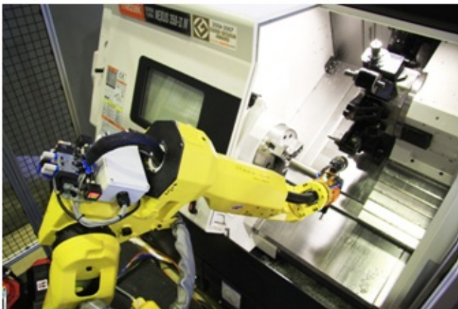
Рисунок 2 — Робот манипулятор устанавливает заготовку в станок
