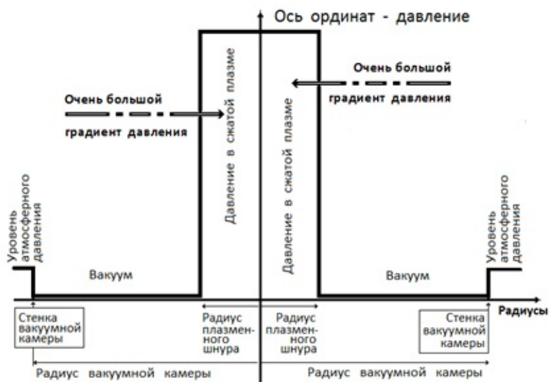
Схематичный график распределения давления: плазменный шнур в вакуумной камере
