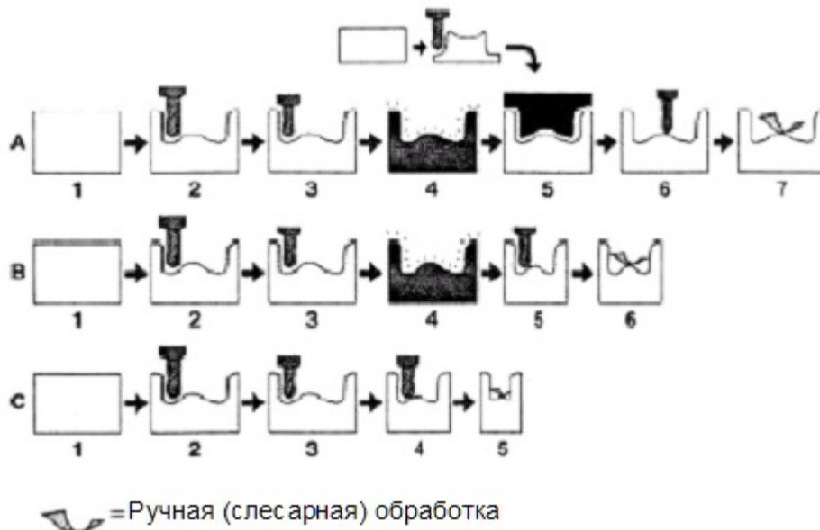
Рис. 4. Усовершенствование производственного процесса с помощью HSM
