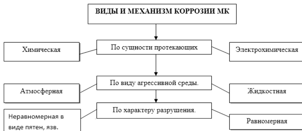
Рис.2 Виды коррозии металлических конструкций.
