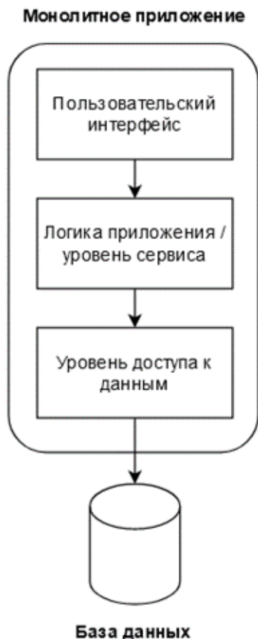
Рисунок 1. Типичное монолитное приложение, состоящее из трех слоев.
