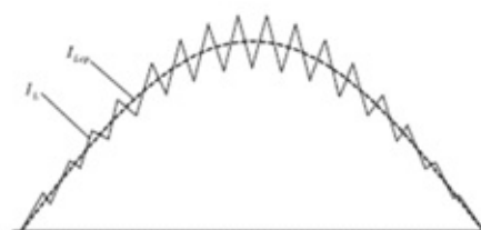
Рисунок 6 – Диаграммы токов при управлении по среднему значению тока
