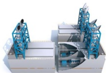
Рисунок 14 — Плавучая платформа P-63 FPSO с тремя энергетическими модулями
