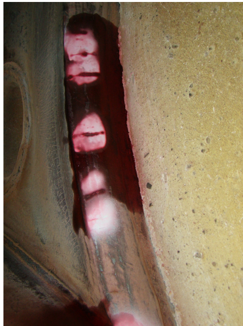
3. Трещины в сварных соединениях трубной решетки и жаровой трубы (Рис.3).
