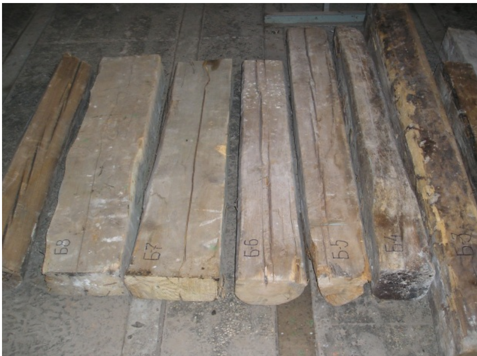
Рисунок 1. Образцы балок из «старой» древесины для испытаний на изгиб
