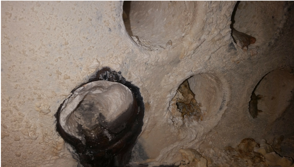
3. Трещины в сварных соединениях трубной решетки и жаровой трубы (Рис.3).
