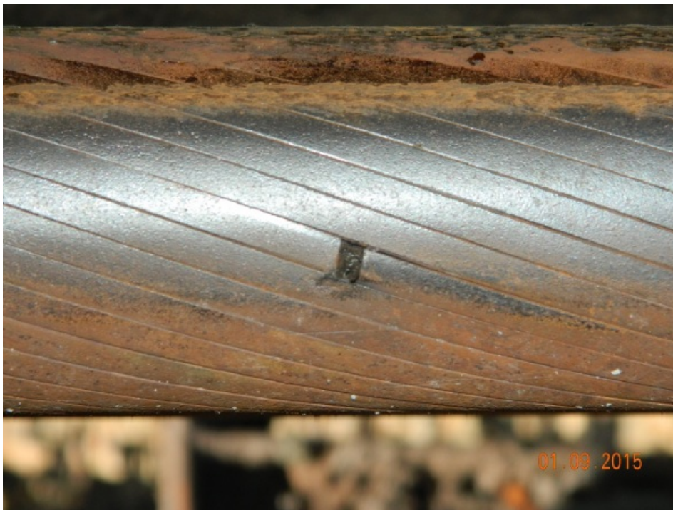
Рис. 2 Обрыв проволоки наружного слоя
