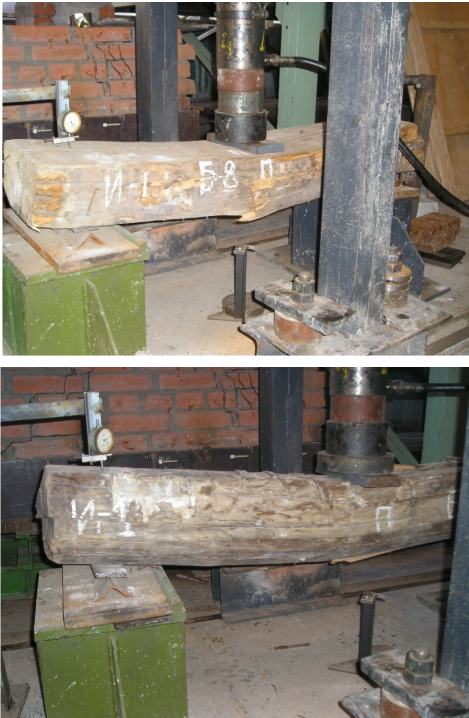
Рисунок 3. Испытание балок из «старой» древесины
