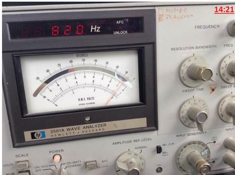
Фото.11. Показание принятого сигнала Антенной МАН№ 8 на дистанции 360 м
