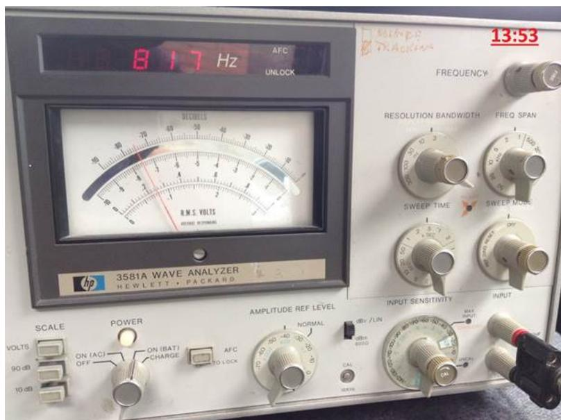
Фото.9. Показание принятого сигнала Антенной МАН№ 8 на дистанции 180 м.
