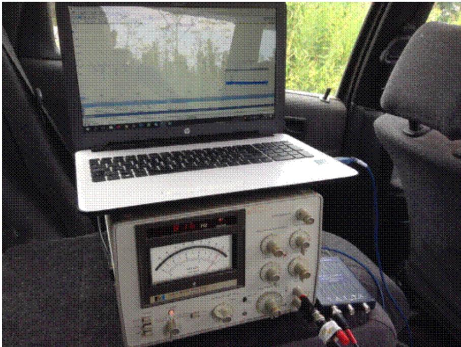
**Фото.7.** Расположение регистрирующей аппаратуры сигнала от МАН $\text{\#}$  8, закреплённой вне салона.
