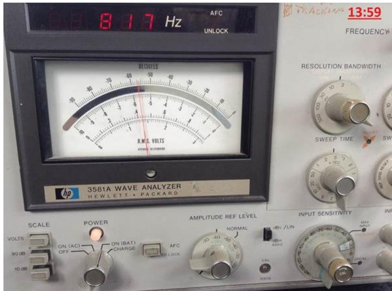
Фото.10. Показание принятого сигнала Антенной МАН№ 8 на дистанции 330 м
