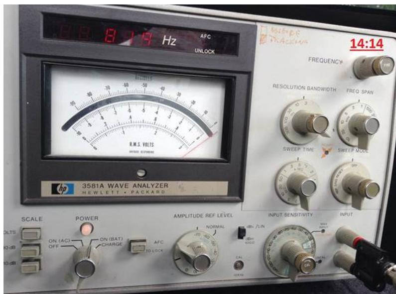
**Фото.12. Показание принятого сигнала Антенной МАН № 8 на дистанции 420 м**
