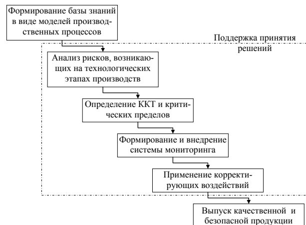
Рис. 1 Функциональная схема «Применение информационно-управляющей системы при производстве пищевых продуктов»
