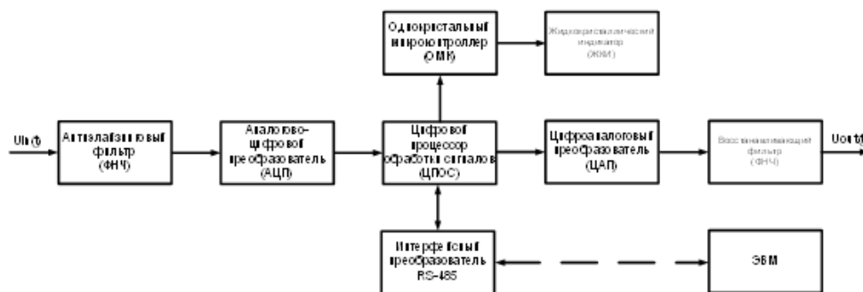
Рис. 1. Структурная схема блока БПФ.
