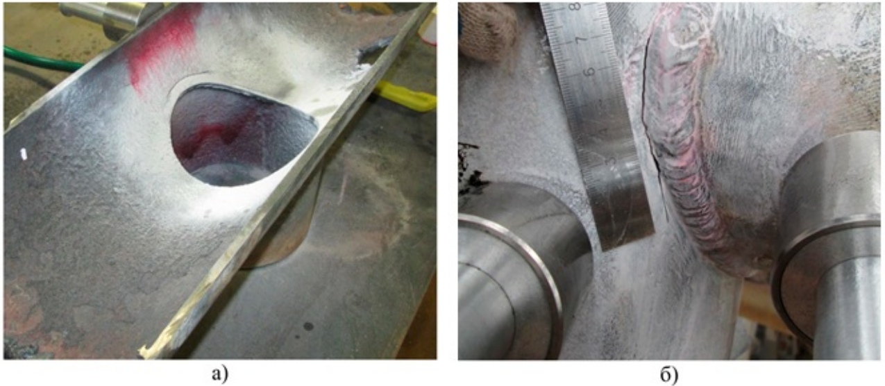
Рисунок 2 – Проведение магнитопорошкового контроля: а) – с внутренней стороны; б) - с наружной стороны.
