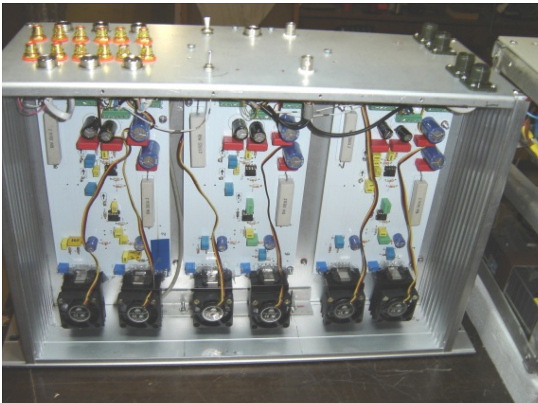
Фото. 16 Усилительные Модули №2 УМ №3 предназначены работать в режиме CW на частоте от 200 Гц до 90 КГц.
