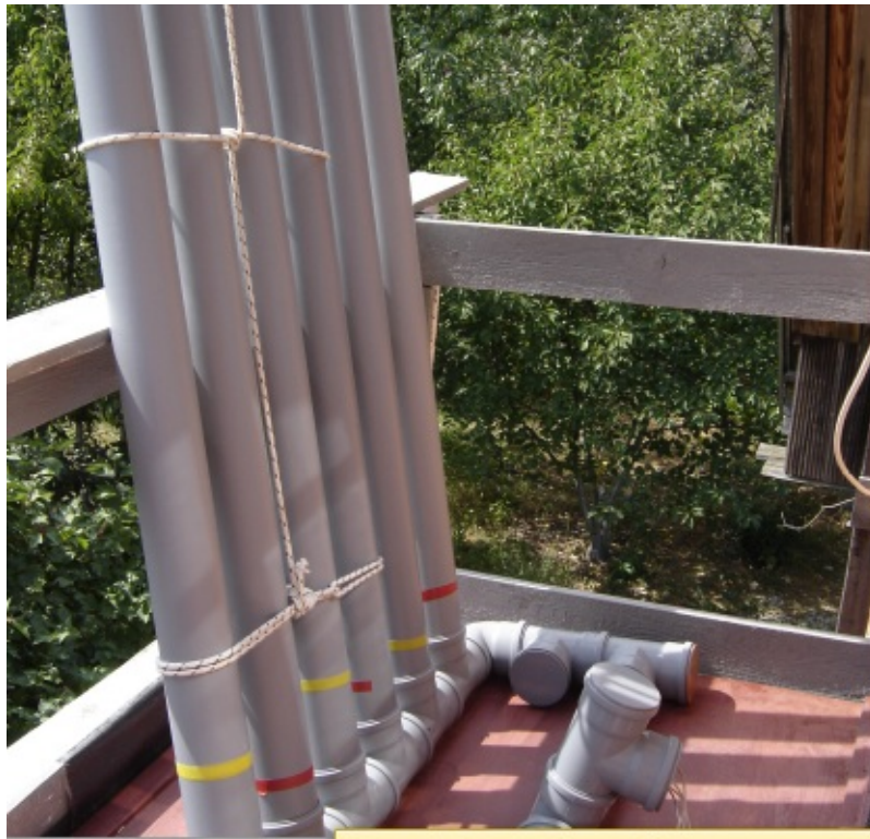
Фото 3. Вид герметичной конструкции "ушестерённой" модели передающей антенны на диапазон ОНЧ
