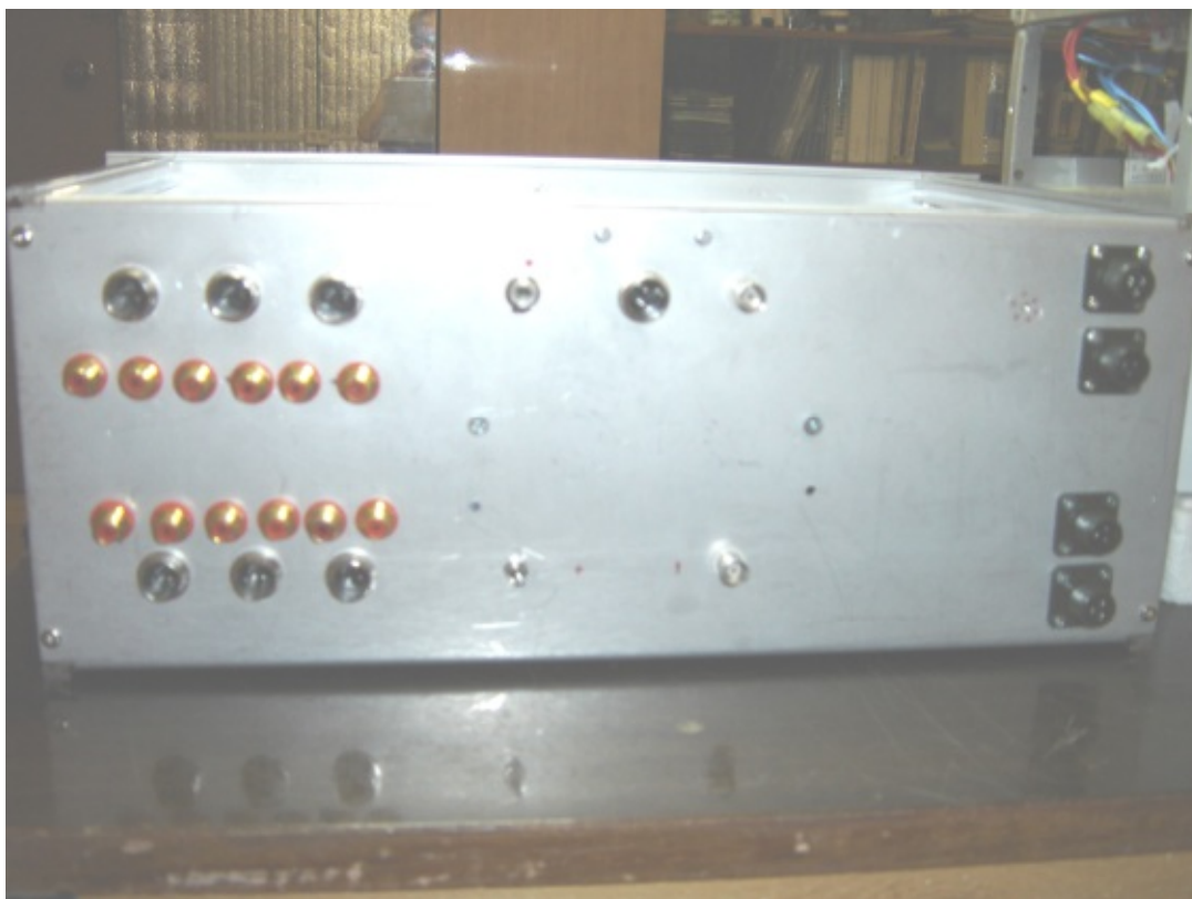
Фото. 15. УМ №3 с БСК№2 предназначен для частот от 16 до 46 КГц.
